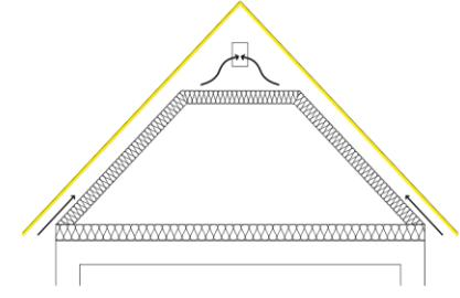
**Рис. 6.8. Эксплуатируемый чердак. Герметичное покрытие**
