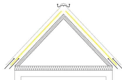
**Рис. 6.5. Эксплуатируемый чердак. Прогреваемое покрытие,**
