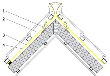
Рис. 7.6. 1. вентиляционный вкладыш, 2. верхняя щель, 3. пленка, 4. нижняя щель
