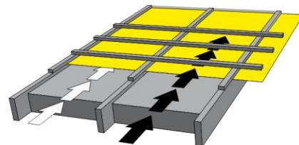
Рис. 6.16. Вентиляция при помощи двух вентиляционных щелей
