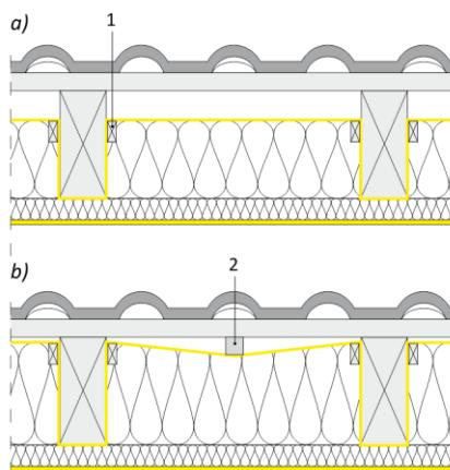
Рис. 7.20. Способы укладки высокопаропроницаемой пленки при реставрации чердака:
