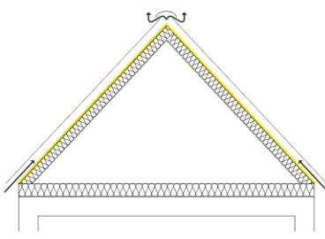
**Рис. 6.6. Эксплуатируемый чердак. Прогреваемое покрытие,**
