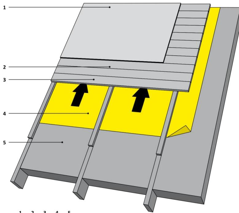
Рис. 6.10. Крыша из ветроизоляционной пленки WIGOFOIL:
