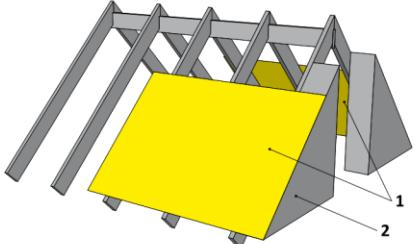
Рис. 7.16. 1 пленка 2 торцевая стена
