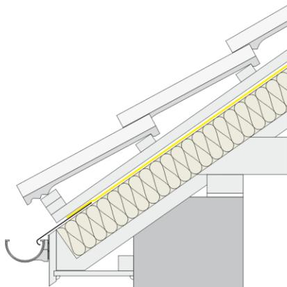
Рис. 7.8. Укладка пленки непосредственно в водосточную трубу
