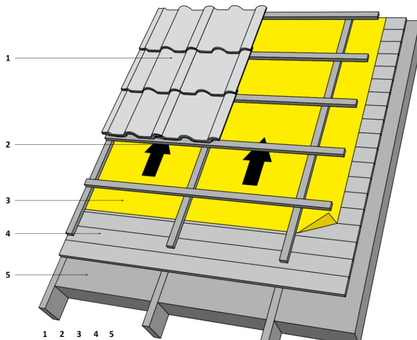
**Рис. 6.13. Крыша из специальной высокопаропроницаемой пленки STROTEX:** 1. основное покрытие, 2. вентиляционная щель, 3. высокопаропроницаемая кровельная пленка (STROTEX) - на обрешетку 4. обрешетка из досок, 5. термоизоляция
