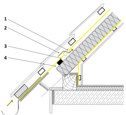
Рис. 7.7. 1. вентиляционный вкладыш, 2. верхняя щель, 3. пленка, 4. нижняя щель
