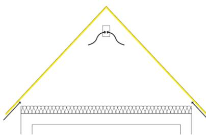
**Рис. 6.7. Неэксплуатируемый чердак. Герметичное покрытие**
