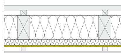
Рис. 6.9. возможные способы расположения пароизоляции
