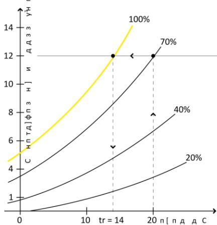
**Нижеприведенный график показывает способ определения точки росы.** Если имеем 1 м<sup>3</sup> воздуха при температуре 20°C, в котором находятся 12 г водяного пара, то его относительная влажность составляет ок. 70% (12 г от максимальных 17,3, которые может поглотить при этой темп.) Если
