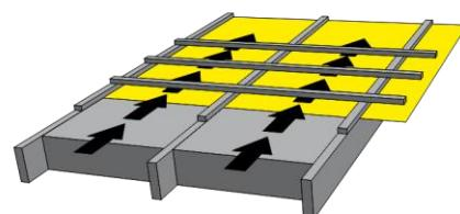
Рис. 6.17. Вентиляция при помощи одной вентиляционной щели
