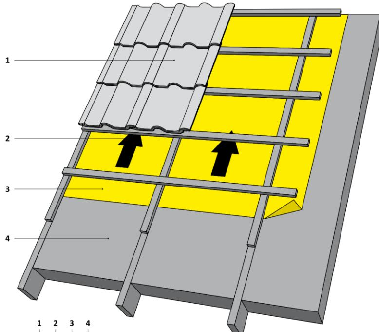
**Рис. 6.12. Крыша из высокопаропроницаемой пленки STROTEX:** 1. основное покрытие, 2. вентиляционная щель, 3. высокопаропроницаемая кровельная пленка (STROTEX), 4. термоизоляция
