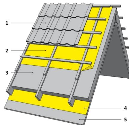
Рис. 6.2. Система слоев в стандартно утепленной скатной крыше с эксплуатируемым чердаком: 1. основное покрытие, 2. слой первичного покрытия – паропроницаемая пленка STROTEX, 3. термоизоляция, 4. пароизоляция – пароизоляционная пленка STROTEX, FOLAREX PI либо EKOFOL, FOLAREX PI либо EKOFOL, 5. плиты k-g
