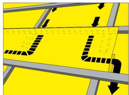
Рис. 7.15. Методы отвода воды желобом
